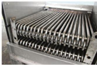
纯304不锈钢盘管，耐腐蚀
